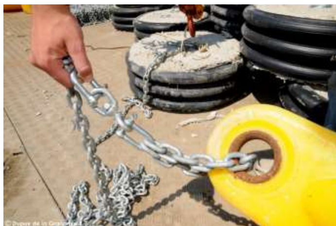
Figure 25: Utilisation d'un émerillon pour le raccord avec la bouée de surface.
