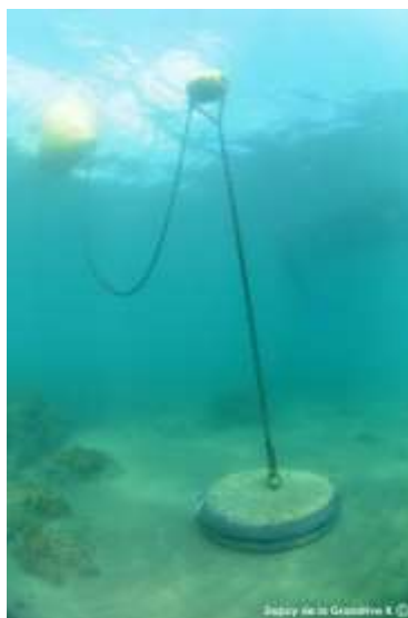
Figure 24: Ligne de mouillage équipée d'un flotteur intermédiaire.
